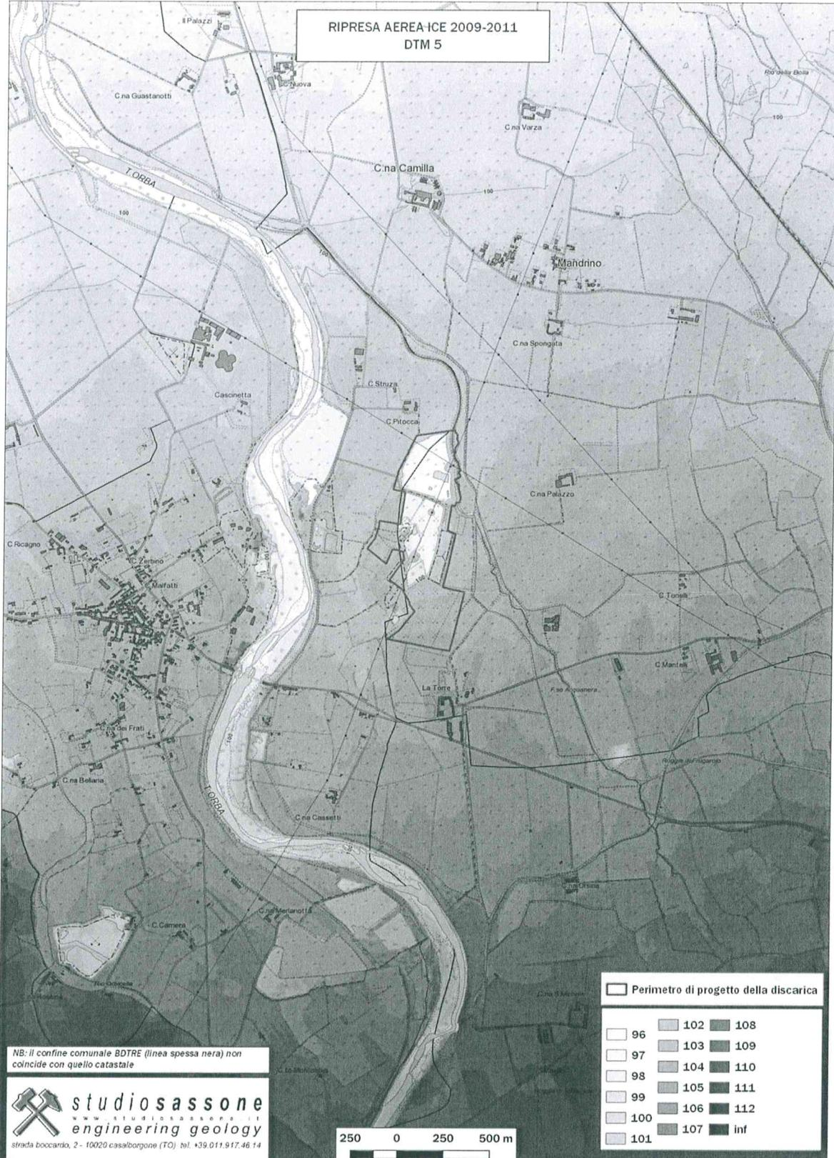
Modello digitale del terreno (DEM) con risoluzione di 5 m, indicante con sfumature di colore le quote altimetriche omogenee, in rosso il perimetro di prevista discarica che sottende le zone depresse derivanti da ex cave di inerti, poste a quote comparabili con l'alveo del T. Orba. Elaborazione su Fonte Regione Piemonte.
